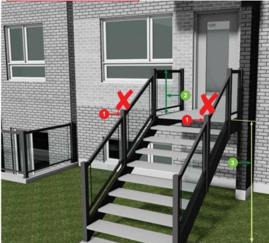
Main courante discontinue dans une volée d'un escalier desservant un seul logement - non conforme
